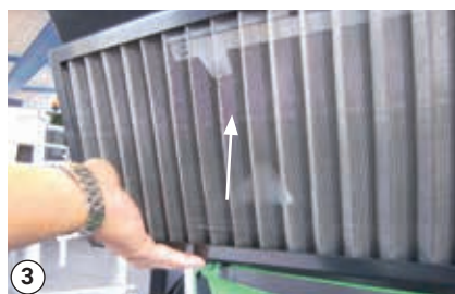
Zvednutím uvolníte vstupní vzduchový filtr
