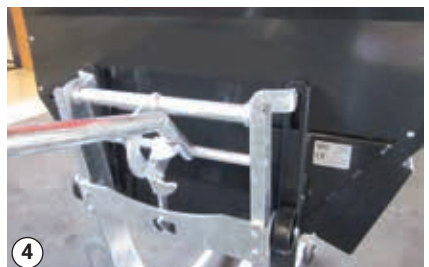
4 Umístěte zásobník na stojan pro připojení/odpojení zásobníku
