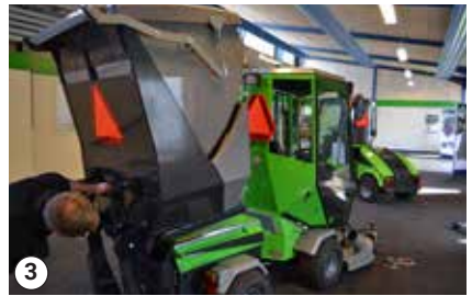
Nejprve zásobník natlačte a potom spusťte přes kryt
