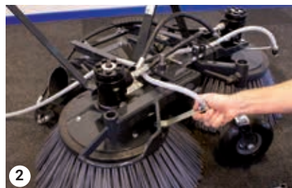
Namontujte upevňovací prvek šroubem
