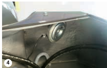
4 Zkontrolujte, že je konektor připojen k reproduktoru.
