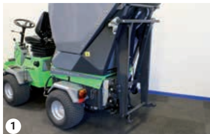
1 Přeprava rámu zásobníku na zásobníku
