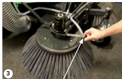
Vodní trysky na přední straně dvou standardních kartáčů
