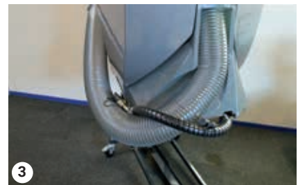
Skladování hydraulických a vodních hadic
