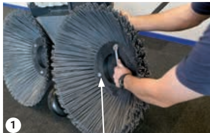
Výměna kartáčů: povolené šrouby
