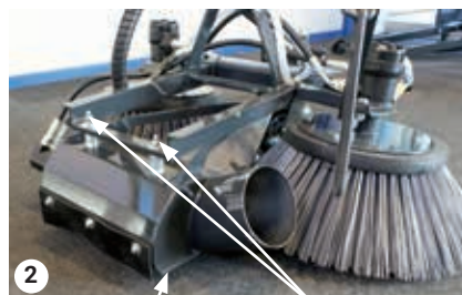
Nastavení výšky Nastavení šroubů
