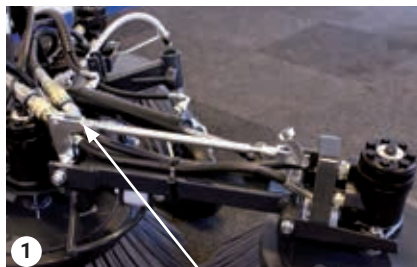
Upínací prvky pro nastavení úhlu dodatečného bočního kartáče
