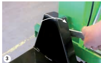
Pojistná páka na rámu A – zavřená
