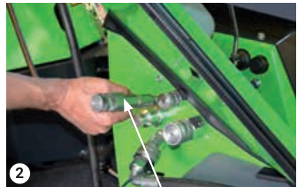
Přepadová olejová hadice na konektoru D-3
