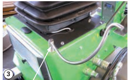
Namontujte držák hadice na závitový kolík vpravo za sedadlem
