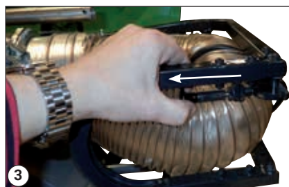
Vytáhněte zámek a otevřete rukojeť
