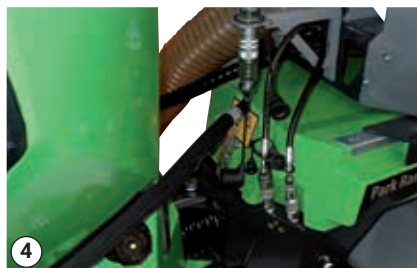
Připojení hydraulické hadice – zadní
