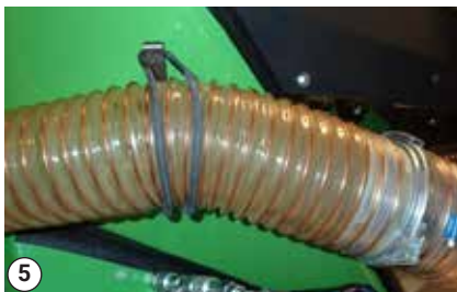
Připevněte sací hadici gumovým popruhem pro stroje s kabinou
