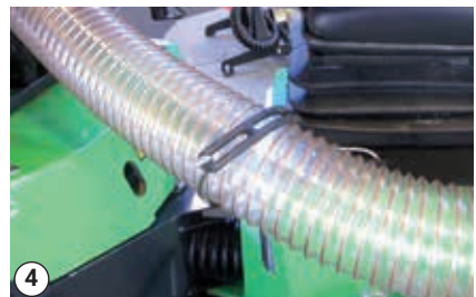
Připevněte sací hadici gumovým popruhem pro stroje bez kabiny
