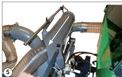
Vyjměte odsávací hubici z držáku
