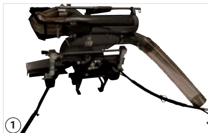
1 Před připojováním rozložte sací hadici a hydraulické hadice do stran
