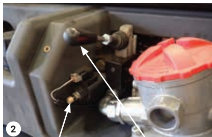
Ventil hydraulického čerpadla
