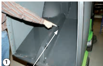
Plastová zarážka na kontrolním otvoru
