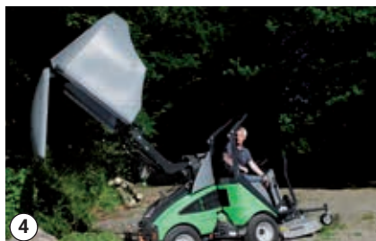
Zásobník se zvedne do max. výšky a vyklápí se co možná nejvíce dozadu
