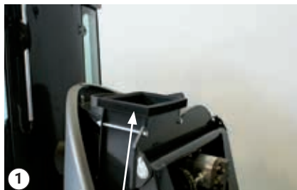
Vyměňte těsnění na turbíně
