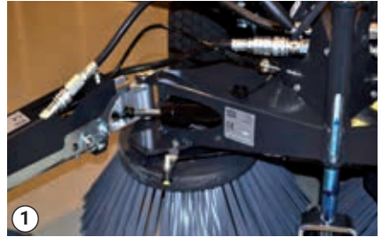
Hydraulické hadice + hadice na vodu sú pripevnené na ráme A
