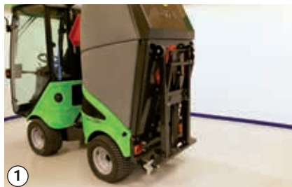
Preprava rámu zásobníka na zásobníku
