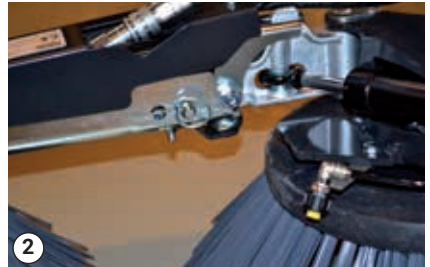
Hydraulické hadice + hadice na vodu sú pripevnené na bočnej kefe
