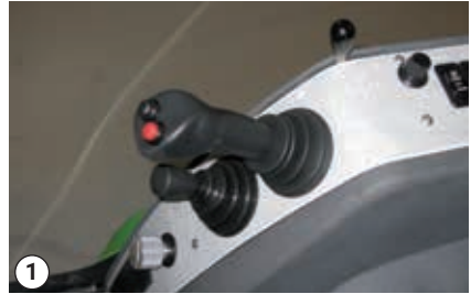
Sněhová V-radlice je zdvižena řídicí pákou
